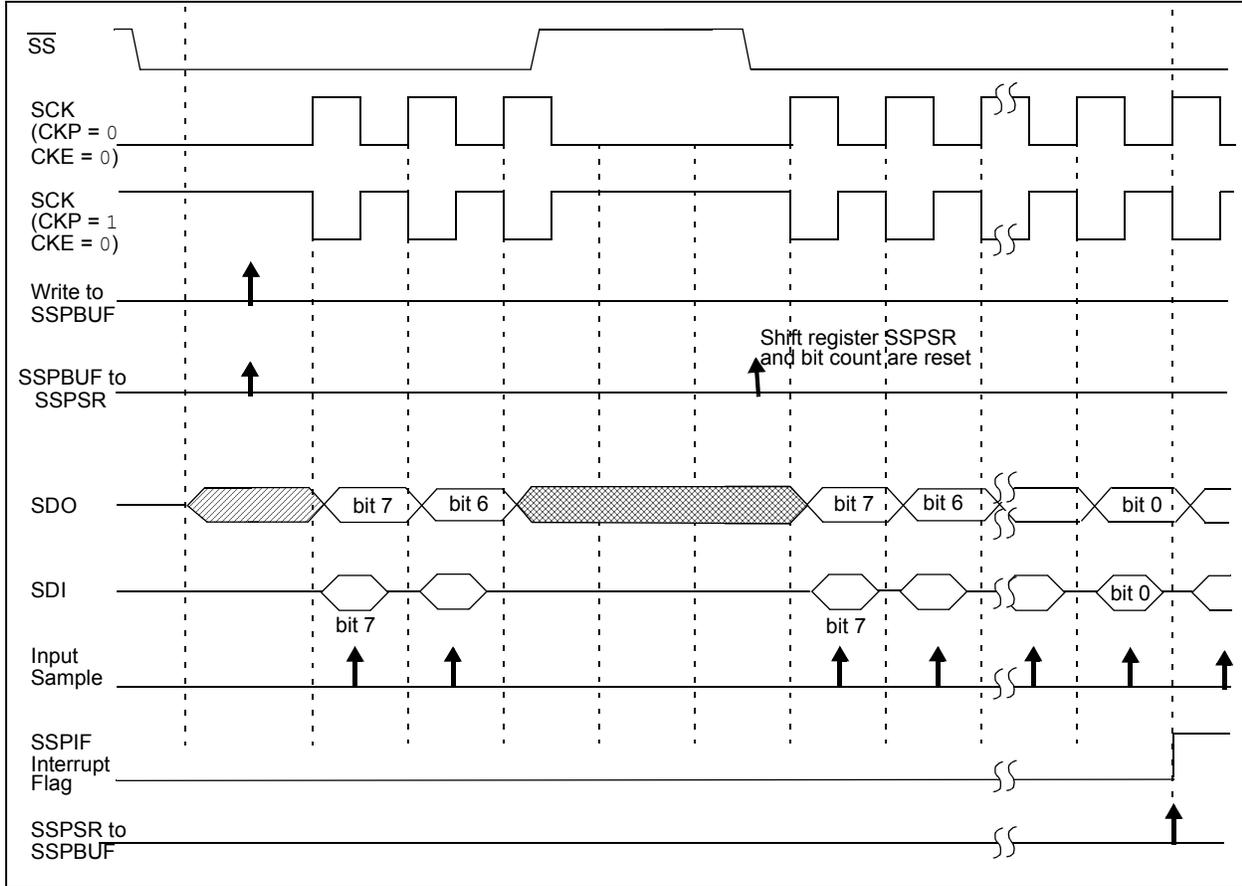
**FIGURE 28-9: SPI MODE WAVEFORM (SLAVE MODE WITH CKE = 0)**
