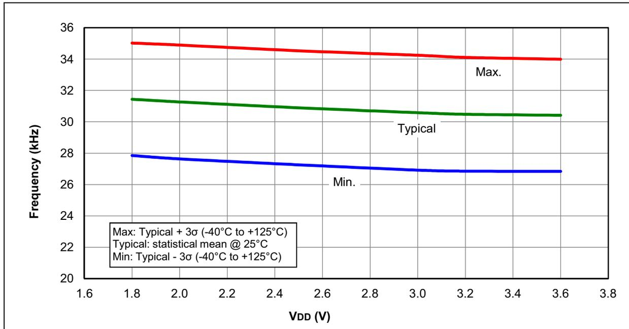
**FIGURE 33-21: LFINTOSC FREQUENCY OVER V<sub>DD</sub> AND TEMPERATURE, PIC16F1705/9 ONLY**
