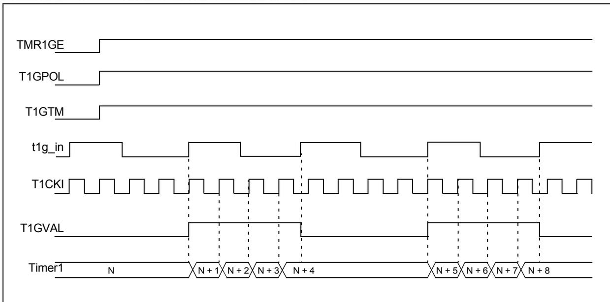
**FIGURE 25-5: TIMER1 GATE SINGLE-PULSE MODE**
