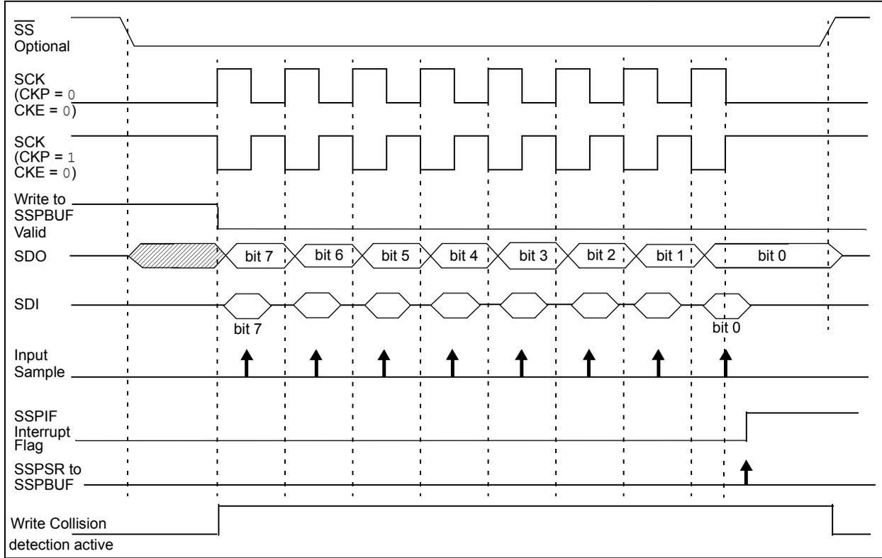
**FIGURE 28-10: SPI MODE WAVEFORM (SLAVE MODE WITH CKE = 1)**
