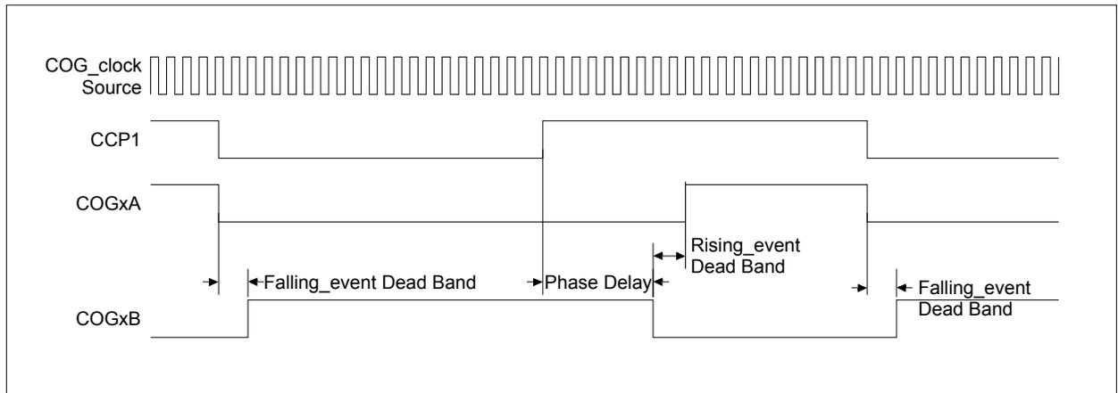
**FIGURE 18-11: PUSH-PULL MODE COG OPERATION WITH CCP1**
