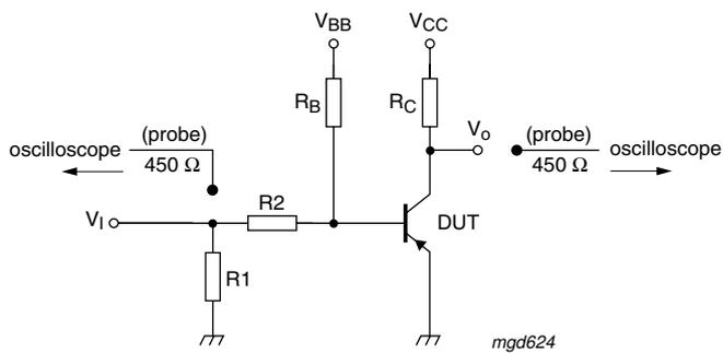
$V_I = 5 \text{ V}$ ;  $T = 500 \text{ } \mu\text{s}$ ;  $t_p = 10 \text{ } \mu\text{s}$ ;  $t_r = t_f \leq 3 \text{ ns}$
