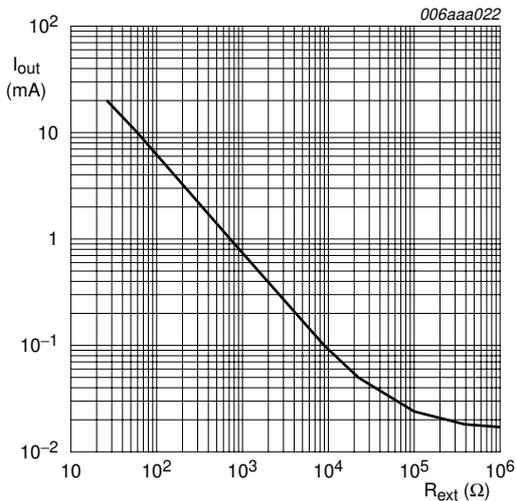
$V_S = 12\text{ V}; R_L = 100\text{ }\Omega$
