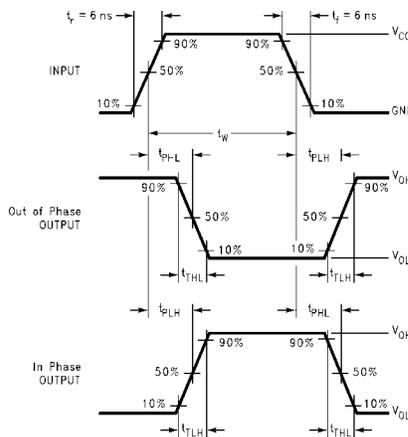
**FIGURE 3. AC Waveforms**
