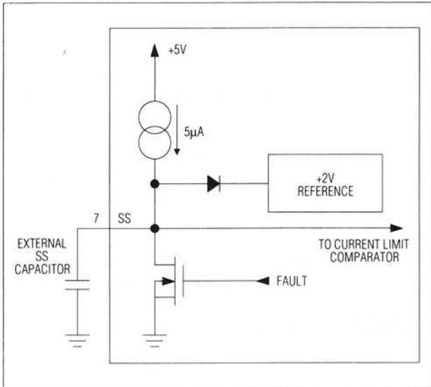
Figure 11. Soft-Start Equivalent Circuit
