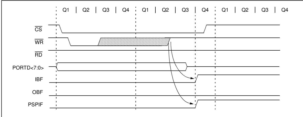
**FIGURE 4-12: PARALLEL SLAVE PORT READ WAVEFORMS**
