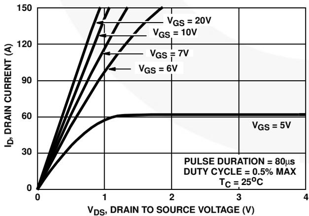
FIGURE 7. SATURATION CHARACTERISTICS
