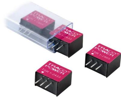
Die Serie der TSR-1 Step-down Schaltregler sind prädestiniert dafür uneffektive 78xx Linearregler zur ersetzen.. Der extrem hohe Wirkungsgrad von bis zu 96 % ermöglicht den Betrieb bei Vollast bis  $+60\text{ °C}$  Umgebungstemperatur ohne Einsatz eines Kühlkörpers oder erzwungener Luftkühlung.
