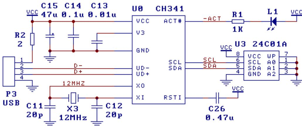
P3 是 USB 端口，USB 总线包括一对 5V 电源线和一对数据信号线，通常，+5V 电源线是红色，接地线是黑色，D+信号线是绿色，D-信号线是白色。USB 总线提供的电源电流通常可以达到 500mA，一般情况下，CH341 芯片和低功耗的 USB 产品可以直接使用 USB 总线提供的 5V 电源。如果 USB 产品通过其它供电方式提供常备电源，那么 CH341 也应该使用该常备电源，如果需要同时使用 USB 总线的电源，那么可以通过阻值约为 1Ω 的电阻连接 USB 总线的 5V 电源线与 USB 产品的 5V 常备电源，并且两者的接地线直接相连接。
