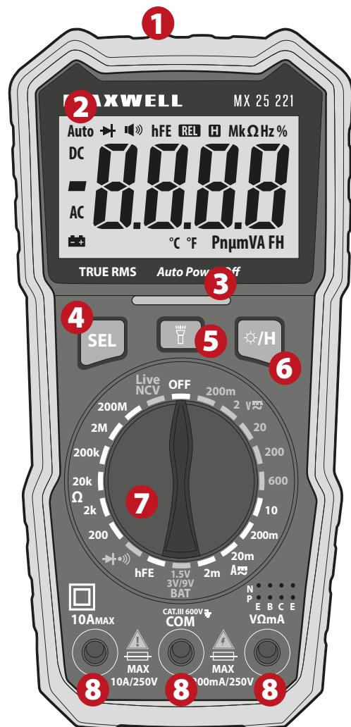
**① NCV bezkontaktné meranie / Pracovné svetlo****② LCD displej: 31,5 mm výška charakteru****③ NCV signalizačné svetlo****④ SEL: Tlačidlo na zmenu funkcie****⑤ Funkcia pracovnej lampy****⑥ Podržanie dát na displeji/zapnutie a vypnutie podsvietenia****⑦ Otočné tlačidlo na výber funkcie****⑧ Vstupné zásuvky**
