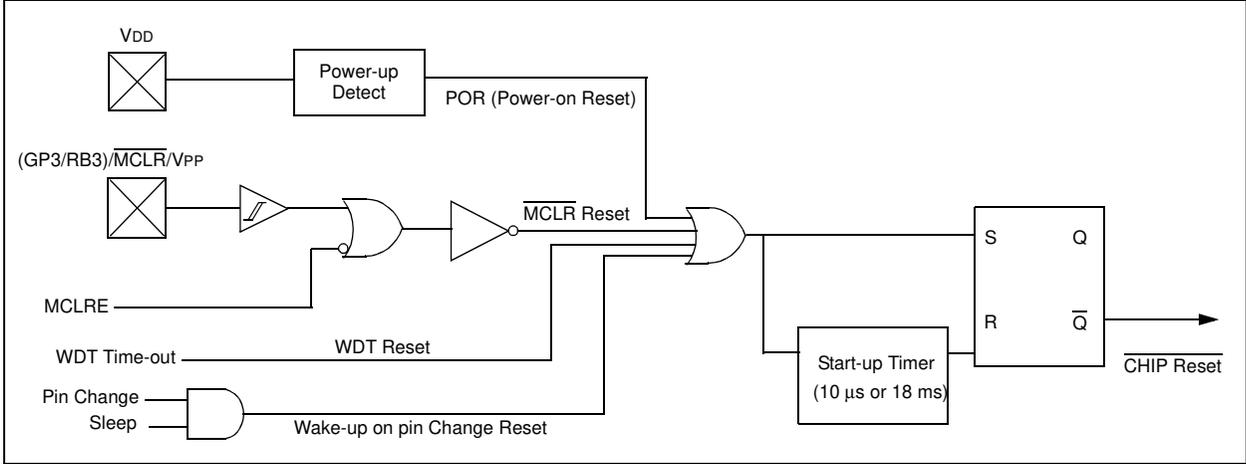
**FIGURE 7-9: TIME-OUT SEQUENCE ON POWER-UP ( $\overline{\text{MCLR}}$  PULLED LOW)**
