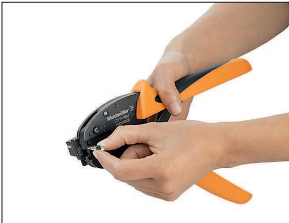
Benötigtes Werkzeug: Crimpwerkzeug PV (1222870000)
