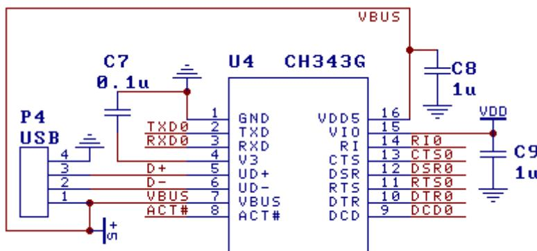
上图是由 CH343G 实现的 USB 转 TTL 串口。图中的信号线可以只连接 RXD、TXD 以及公共地线，其它信号线根据需要选用，不需要时都可以悬空。
