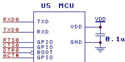
上图是双供电方式下 MCU 单片机通过 TTL 串口连接 CH343 芯片实现 USB 通讯的参考电路。CH343 由 USB 总线供电 VBUS，MCU 及 VIO 使用另一自供电电源 VDD，VDD 支持 5V、3.3V、2.5V、1.8V。
