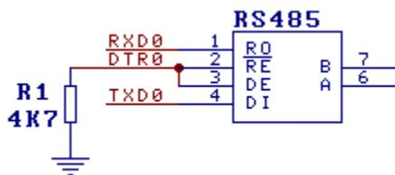
图中 DTR 引脚外接下拉电阻，从而切换为 TNOW 引脚，用于控制 RS485 收发器的 DE（高有效发送使能）和 RE#（低有效接收使能）引脚。RS485 收发器应该与 VIO 使用同一供电电源。
