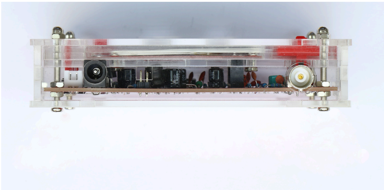
4: M3 anya távtartóként szolgál az alaplaphoz. A teljesen összeszerelt eszköz oldalnézete.
