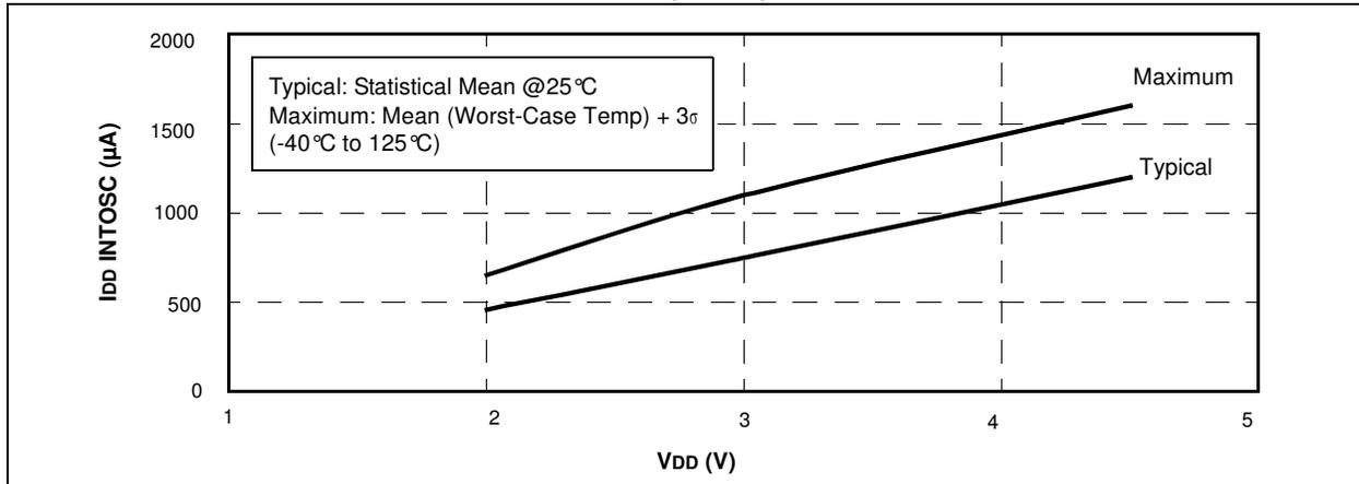
**FIGURE 17-25: PIC12HV609/615 I<sub>DD</sub> EXTRC (4 MHz) vs. V<sub>DD</sub>**
