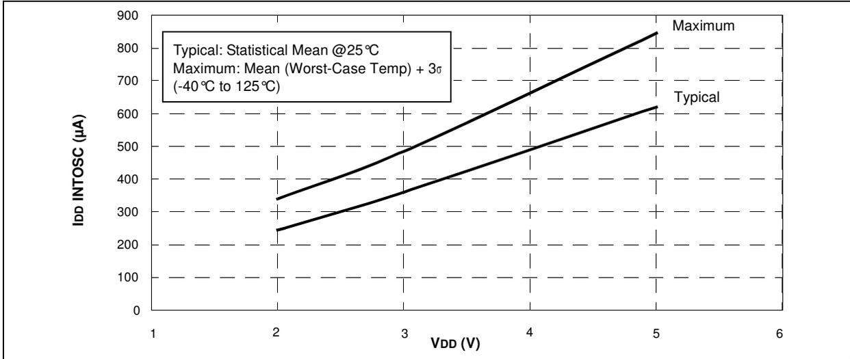
**FIGURE 17-7: PIC12F609/615/617 I<sub>DD</sub> INTOSC (8 MHz) vs. V<sub>DD</sub>**
