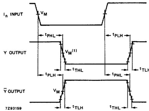
(1) HC :  $V_M = 50\%$ ;  $V_I = \text{GND to } V_{CC}$ .
