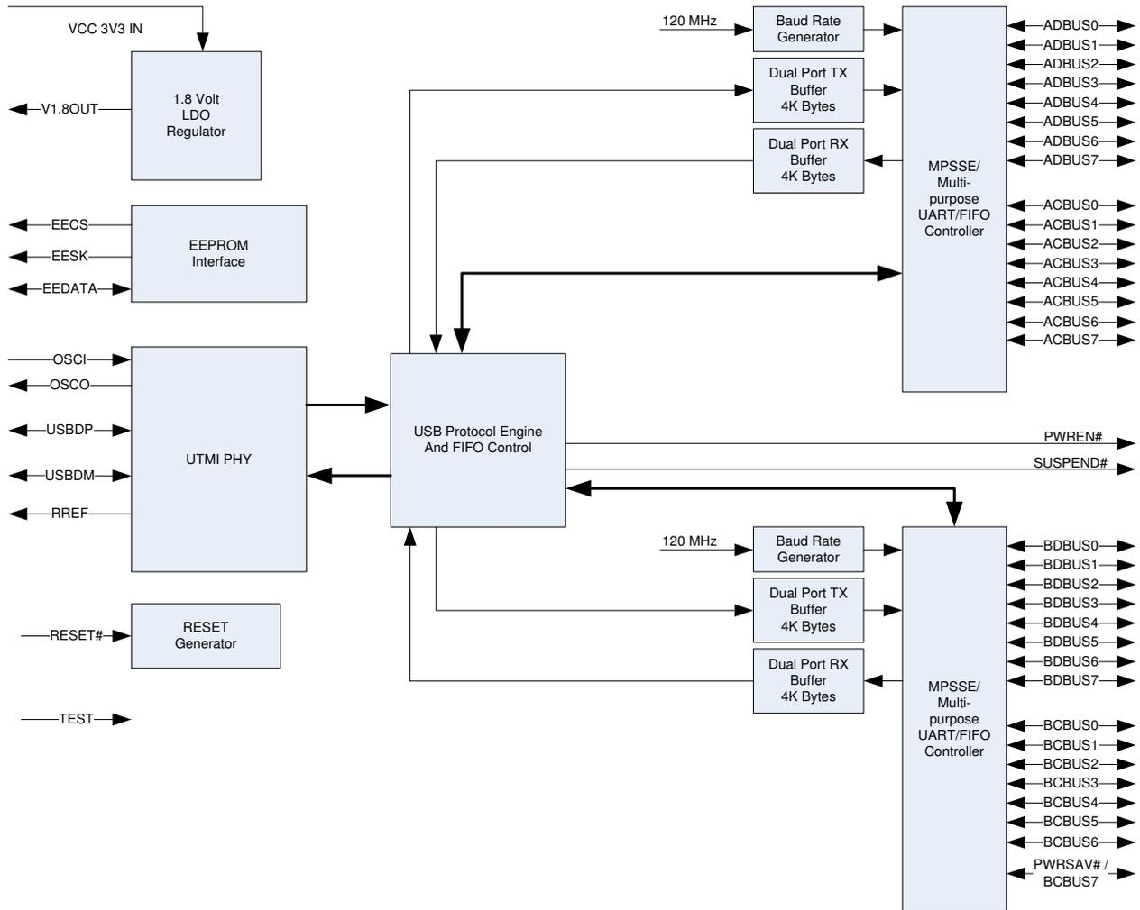
**Figure 2.1 FT2232H Block Diagram**
