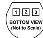
PIN 1, +V<sub>S</sub>; PIN 2, V<sub>OUT</sub>; PIN 3, GND
