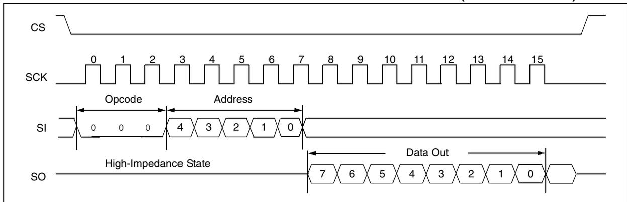
**FIGURE 4-4: READ CONTROL REGISTER COMMAND SEQUENCE (MAC AND MII REGISTERS)**
