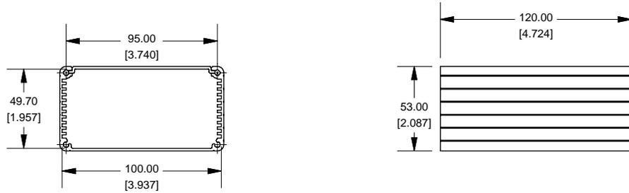
EXTRUSION DESIGNED FOR 100MM WIDE PC BOARD
