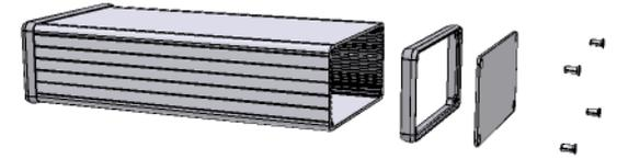
EXTRUSION DESIGNED FOR 100MM WIDE PC BOARD
