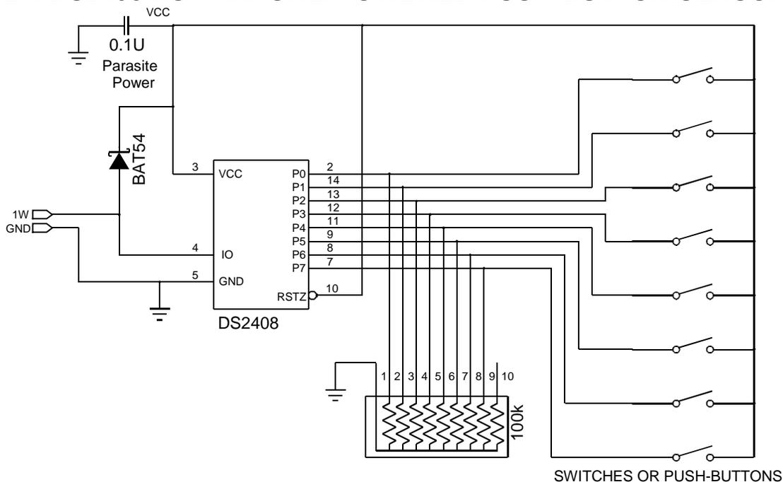
**Figure 22. DS2408 AS MULTIPURPOSE SENSOR/ACTUATOR**
