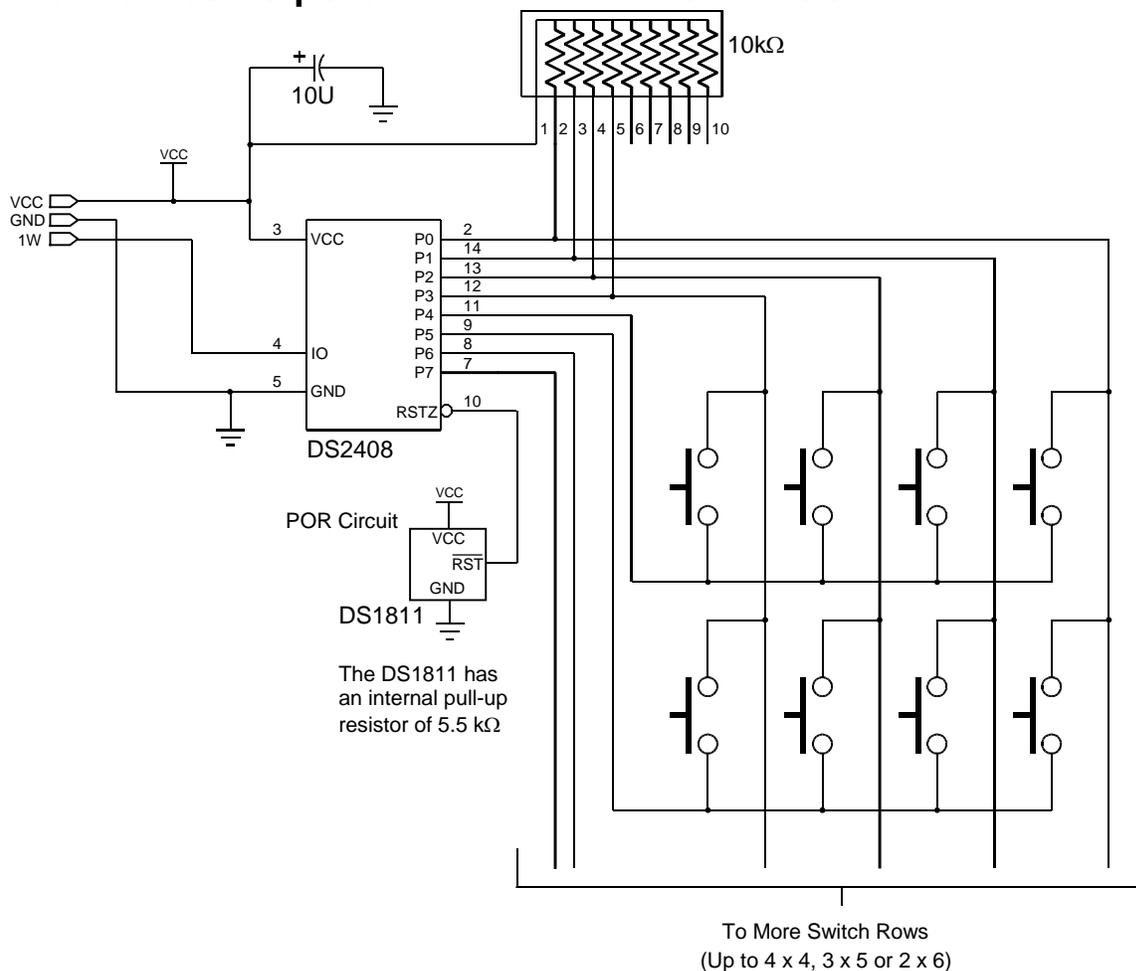
**Figure 21. DS2408 AS PARASITE-POWERED PUSH-BUTTON SENSOR**
