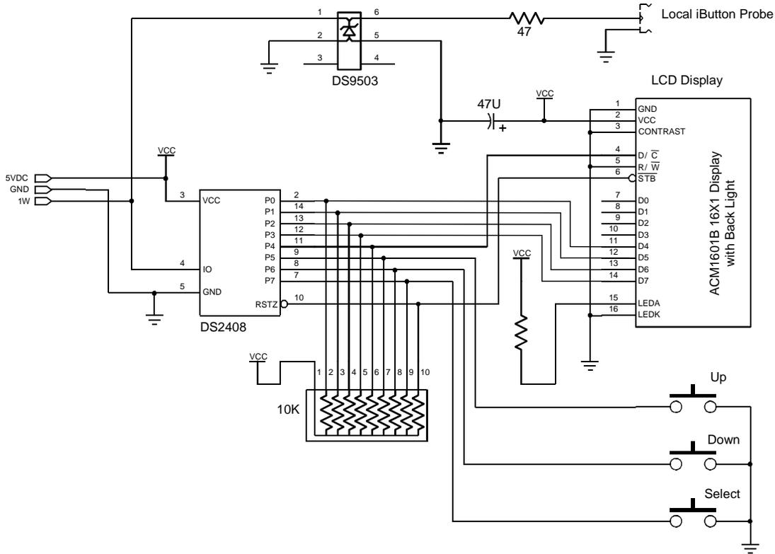
**Figure 19. DS2408 AS MICROCONTROLLER PORT EXPANDER**
