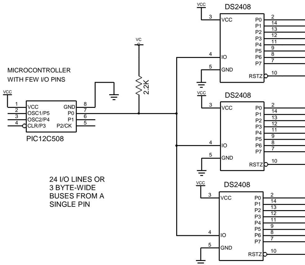
**Figure 20. DS2408 AS  $\mu$ C-OPERATED KEYBOARD SCANNER**
