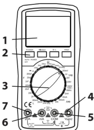
**1.** LCD: kijelzi a mért értéket és a mértékegységet;
